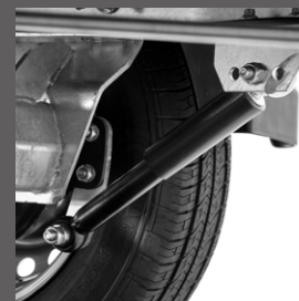
Radstoßdämpfer (montiert) inkl. 100 km/h Bestätigung*
