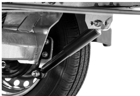
Radstoßdämpfer, für 100 km/h Ausführung (optional)
