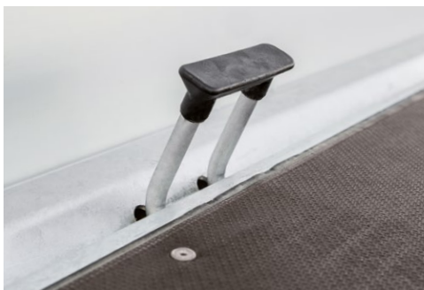
Serienmäßig im Außenrahmen integrierte Zurrbügel
