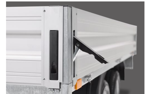
Klappe mit versenkten Verschlüssen
