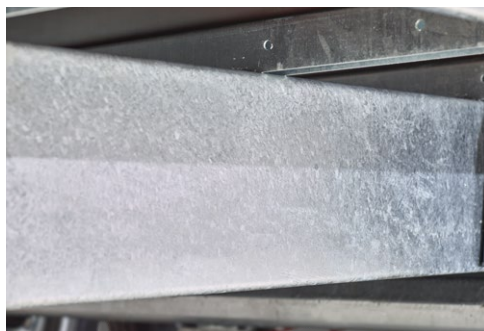
Rahmen und Fahrgestell Tauchbad feuerverzinkt
