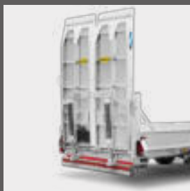
Einteilige, breite Rampen mit Stahlgitterrost
