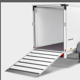
Überfahrwand anstatt Tür hinten
