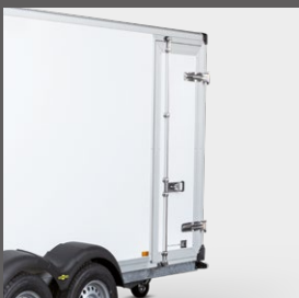
Seitentür mit Drehstangen- verschluss von Innenhöhe 1500 - 2300 mm
