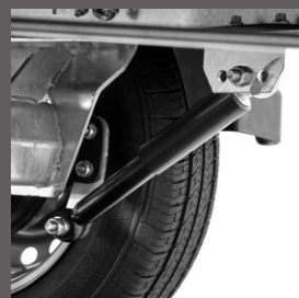
Radstoßdämpfer (montiert) inkl. 100 km/h Bestätigung Radstoßdämpfer (lose) ohne 100 km/h Bestätigung
