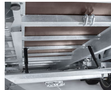
Extreme Stabilität durch eine geboltzte, genietete und verschraubte Brücke mit durchgehenden Brückenlängsträgern
