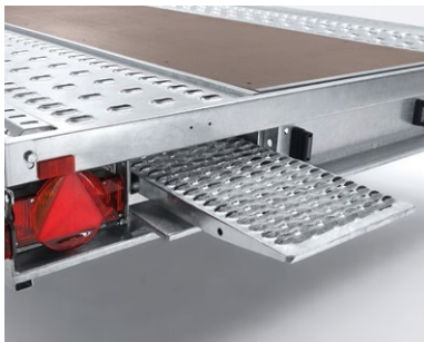
Im Bohlenschacht einschiebbare feuerverzinkte Stahlbohlen
