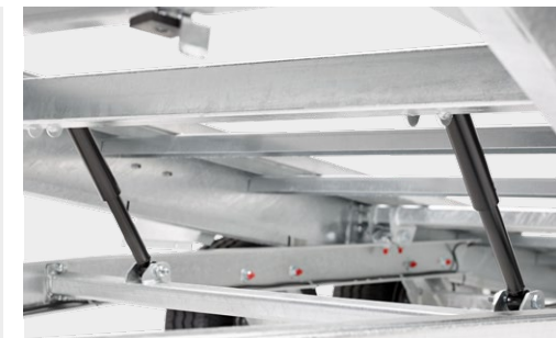
Stoßdämpfer für die mechanischen Kippfunktion
