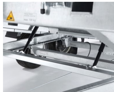
Brücke mit speziellem Kipplager
