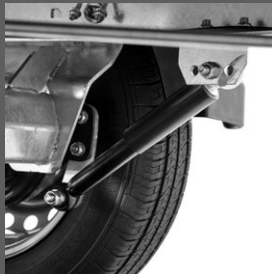
Radstoßdämpfer inkl. 100 km/h Bestätigung
