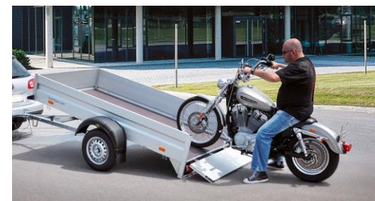
Auffahrsituation beim kippbaren HA
