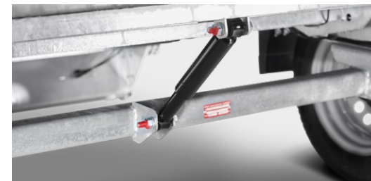
Kippbarer Kasten Aufbau (beim HA kippbar) mit Stoßdämpferunterstützung
