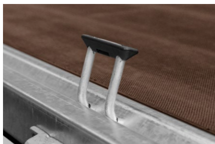
V-Nut Außenrahmen mit 2 Paar versenkten Zurrbügeln
