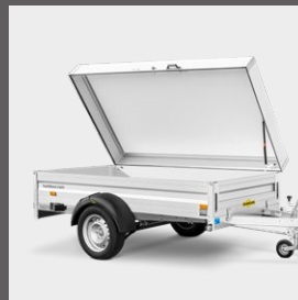
Holz-Alu-Deckel bei Grundbordwand
