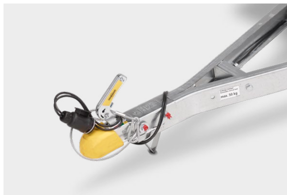
Feuerverzinkte V-Zugdeichsel mit Querstrebe
