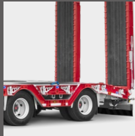
Außenrahmen feuerverzinkt und lackiert nach RAL
