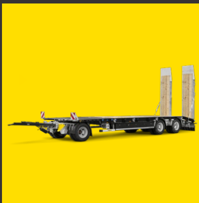
3 m Ausrüstungspaket - Klappausleger und Holzbohlen
