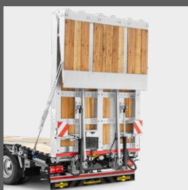
2-teilige Überfahrwand über die gesamte Breite mit Holzbohlenbelag
