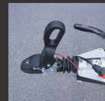
Sicherheitskupplung mit Spurstabilisierung
